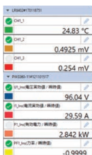
监视器显示 (最多 512 个项目)
