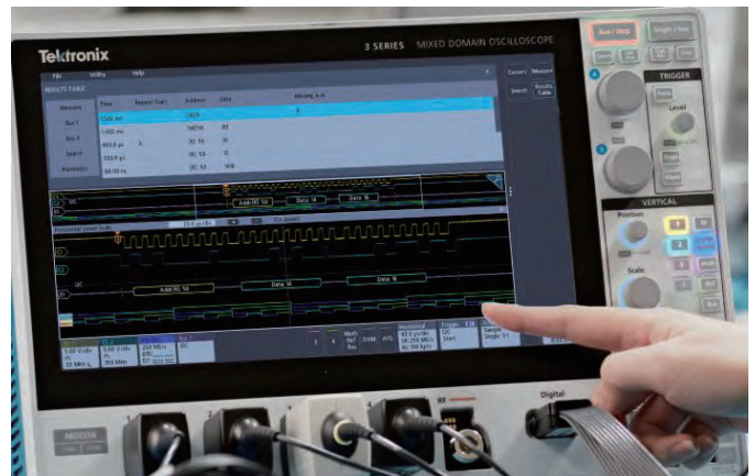
容性触摸显示器上的交互方式与手机和平板电脑相同。
