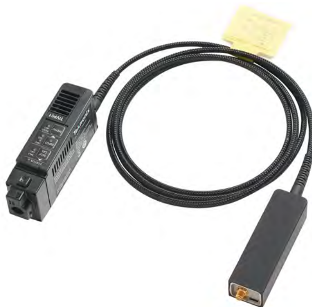
泰克 TIVP 系列 IsoVu™ 测量系统提供了电流隔离测量解决方案，在存在大的共模电压时可以准确地解析高达 2,500 Vpk 以上的高带宽差分信号，在带宽范围内提供了同类优秀的共模抑制性能。
