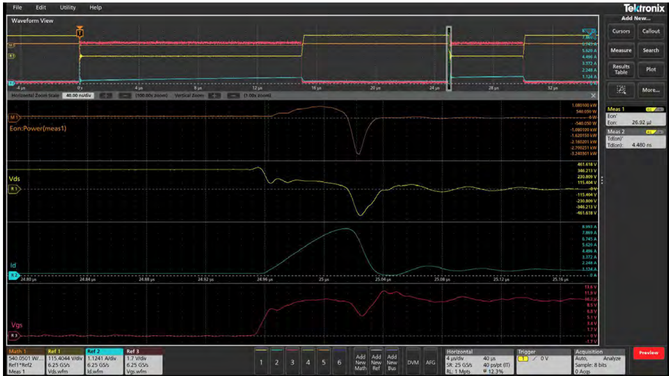
此图显示二极管反向恢复测量以及在低侧捕获的反向恢复电流和电压。
