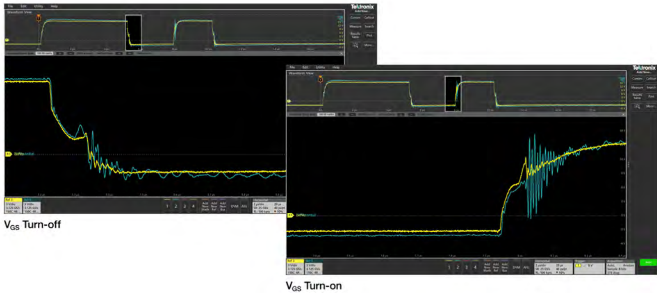
差分探头（蓝色谱线）与 IsoVu 光学隔离探头（黄色谱线）
