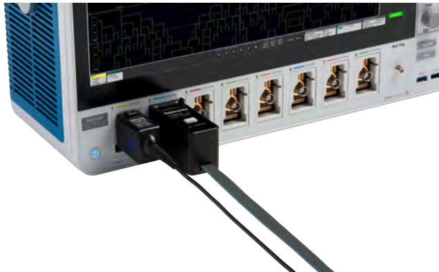
FlexChannel 技术支持更高的灵活性。依据连接的探头类型, 每个输入可以配置成一条模拟通道或 8 条数字通道。
