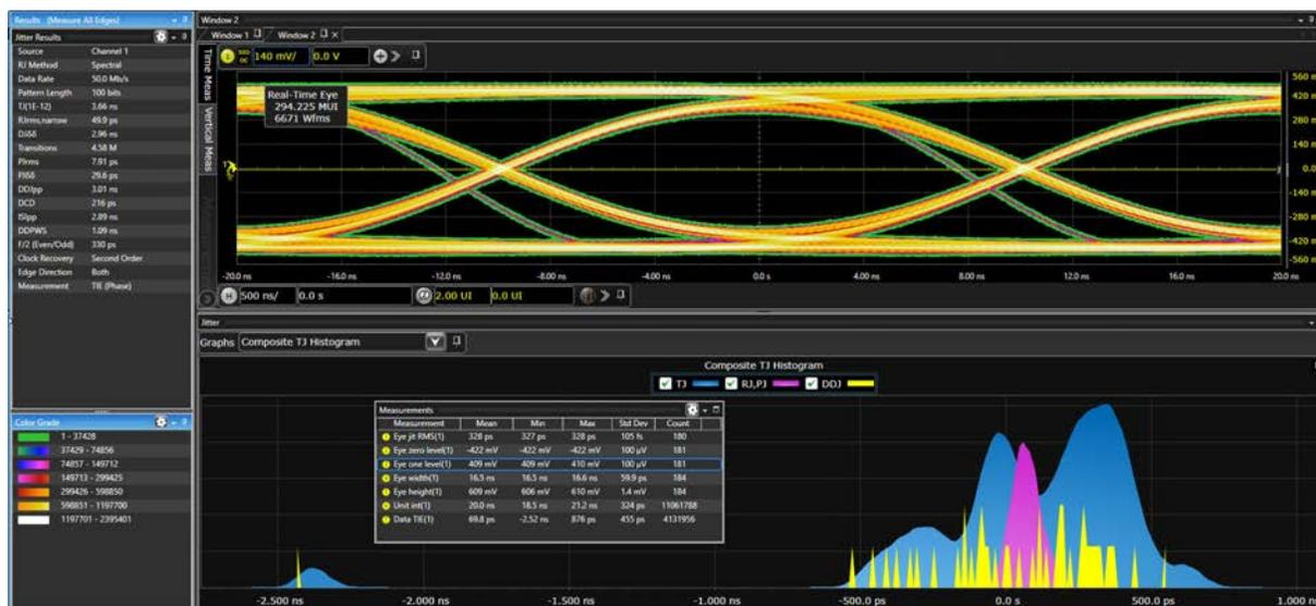
这款软件套件可在垂直（电压）和水平（时间）域中对高速数字接口进行先进的统计分析以及相位噪声分析。上图：完整的实时示波器抖动和噪声分析软件。
