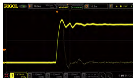
高刷新率模式下捕获偶发异常信号
